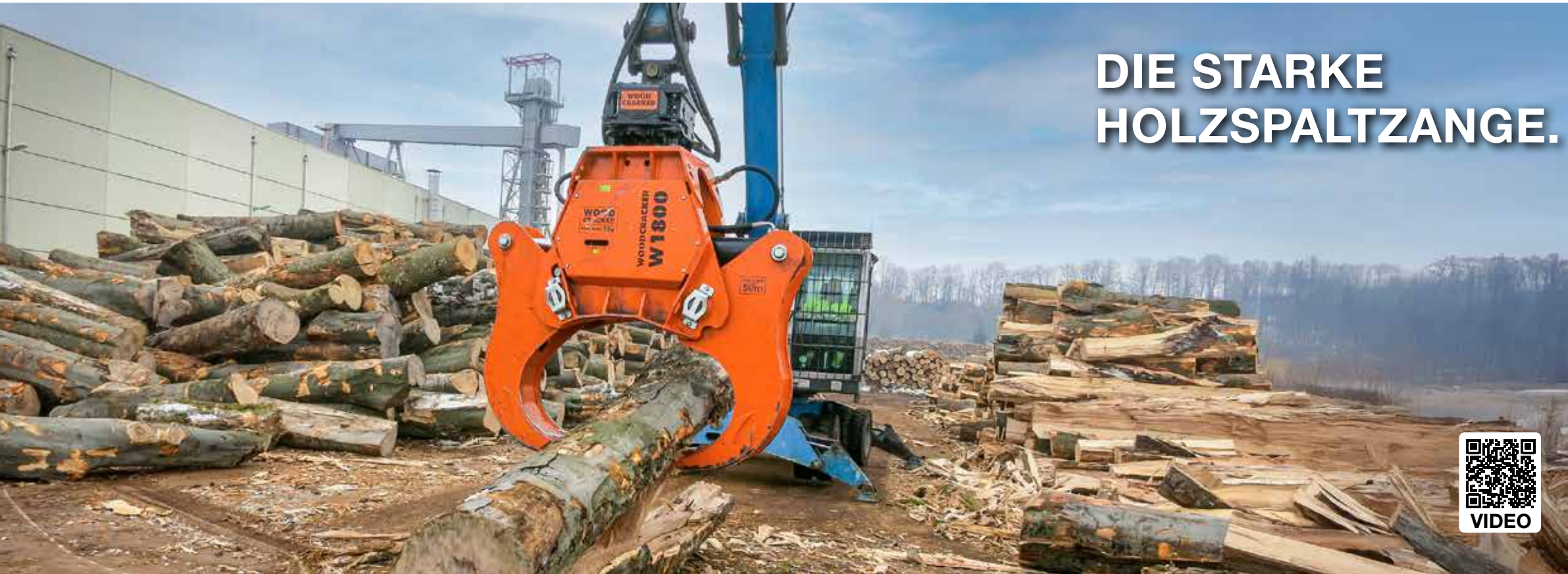
Vorspalten von Material für eine natürliche Trocknung.
