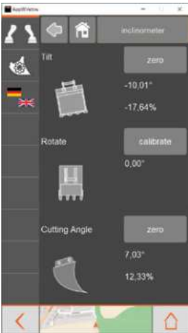
Geometrie-Übersicht des Anbaugerätes und Schnittstelle zu 2D/3D-Systemen
