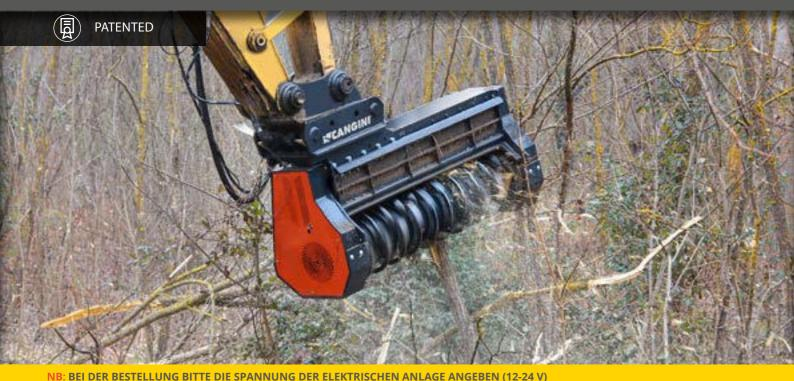
DER FORSTMULCHER DIENT DAZU, DIE SCHWIERIGSTEN ARBEITEN IN DER FORSTWIRTSCHAFT ZU BEWÄLTIGEN: DIE TIEFENREINIGUNG VON WÄLDERN UND GROSSWÄLDERN. ER BENUTZT DAZU EINEN KOLBENMOTOR, DER ES ERMÖGLICHT, SEHR INTENSIVE ARBEITSRHYTHMEN ZU BEWÄLTIGEN. DIE VERSION FÜR BAGGER
