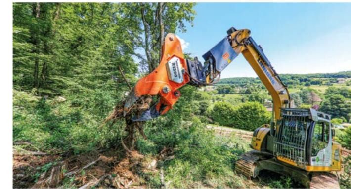
Schonende Entnahme des Stocks aus dem Boden.
