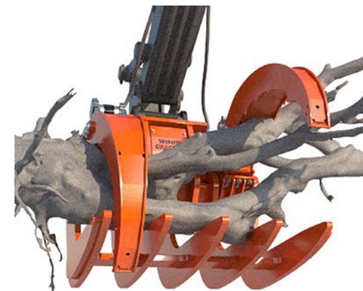
individuelle Anpassung der Greiffinger an das Erntegut
