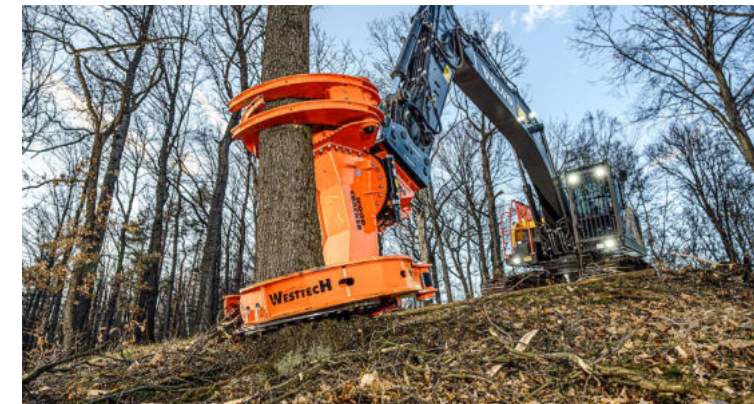
Schneiddurchmesser bis 700 mm.
