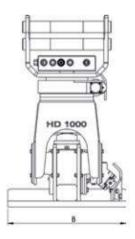
Zum besseren Handling im Betriebshof oder auf der Baustelle verfügen auch diese beiden Modelle über Stapleraufnahmen, um einen einfachen und sicheren Transport zu gewährleisten.
